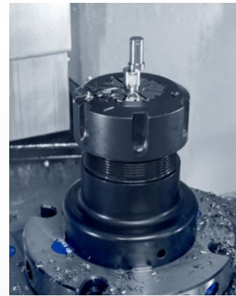
Preci-Point Spannanzengfutter. Bild: Ratiotechnik Milde GmbH.
