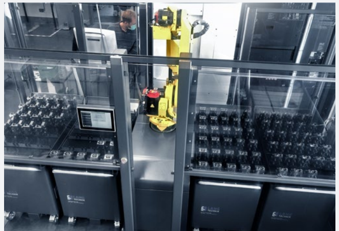
RoboTrex 52 mit vier Automationswagen an einer DMU 60evo. Bild: Peter Josef Klein Feinmechanik GmbH
