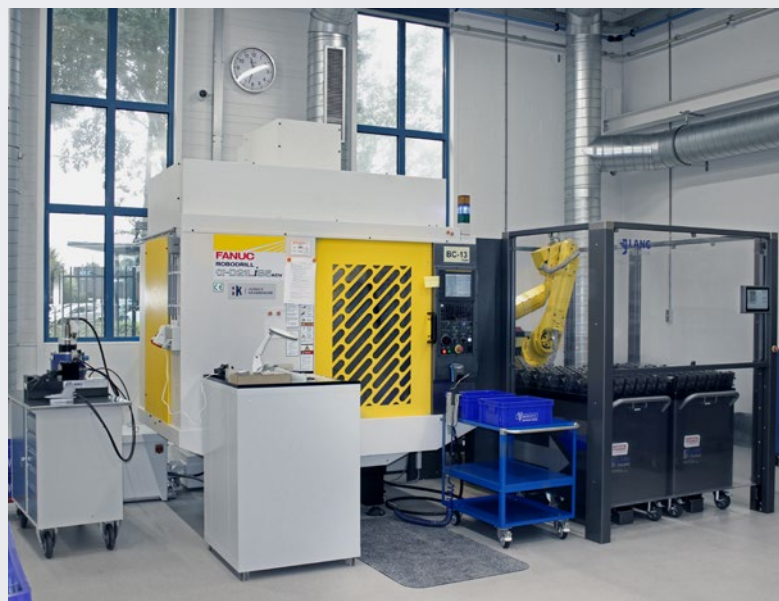
Fanuc Robodrill mit RoboTrex 52 Automationssystem. Bild: Vedos Verspanende Technik B.V.
