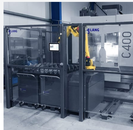
RoboTrex 52 mit vier Automationswagen an einer Hermle C 400.
