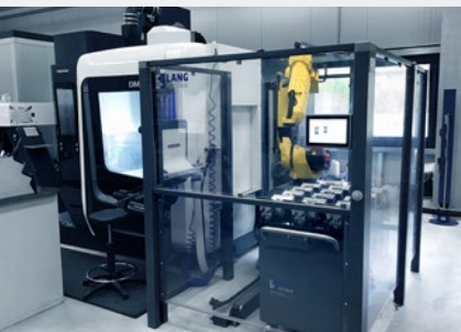
RoboTrex 52 nachgerüstet an einer DMU 50 von DMG Mori.
