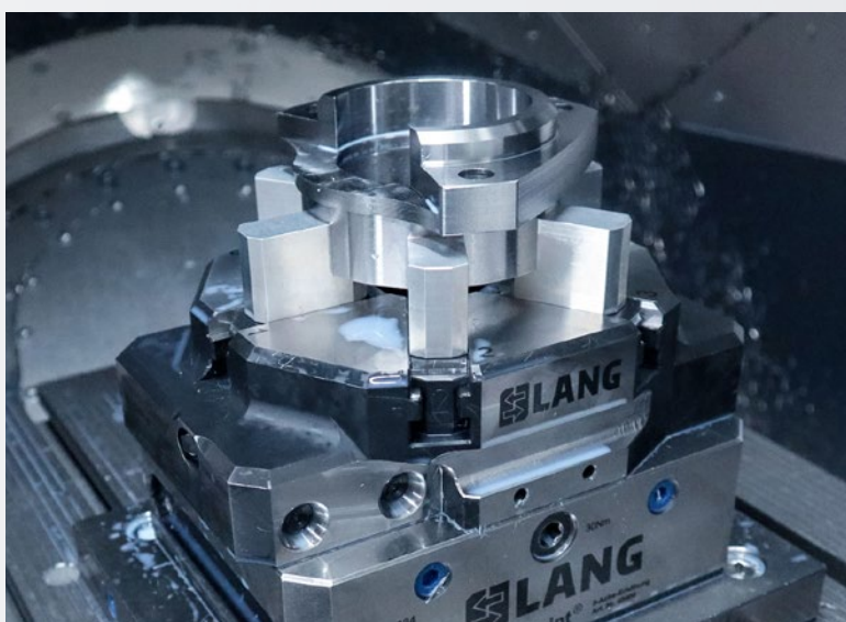
Vasto-Clamp 6-Backenfutter. Bild: CNC-Technik Ortlieb GmbH & Co. KG.
