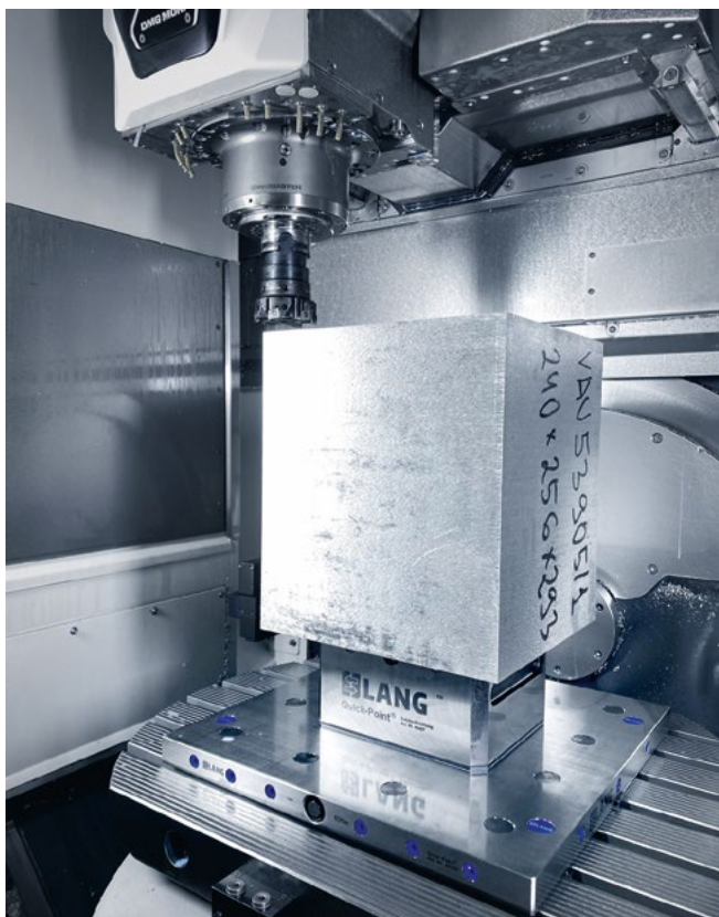
Non seulement très précis, mais aussi très résistant. Quatre pions de fixation sont directement vissés dans la pièce à usiner d'environ 50 kg.
