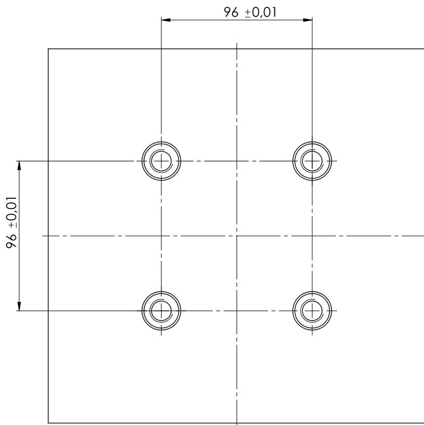
**Les pions doivent être positionnés dans leurs propres dispositifs de serrage et montages avec une précision dimensionnelle de  $96 \text{ mm} \pm 0,01 \text{ mm}$ .**
