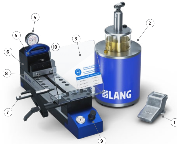
Abbildung: Prägestation Werkbank
